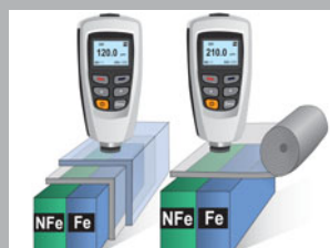
Medición del espesor de capas y del grosor de láminas
