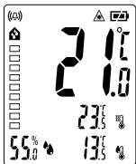
Kondensatsioonniiskuse oht puudub
