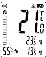
Κανένας κίνδυνος υγρασίας συμπύκνωσης
